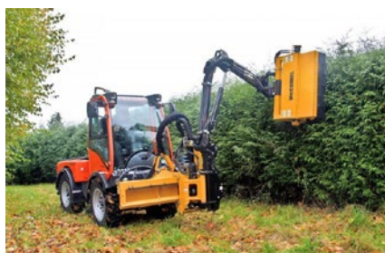
McConnell Armklippare med räckvidd 3,2-9 m för montage på traktor/mini-lastare eller redskapsbärare.
